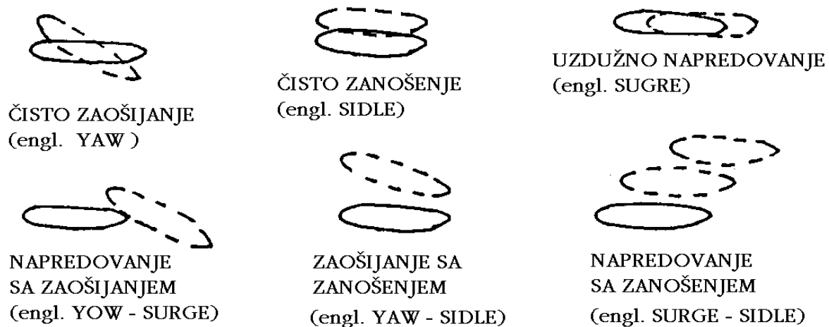
Sl. 1.4 Gibanja broda s malim brzinama napredovanja (manevar u luci primjenom poprečnih sila)
